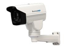
Die L-KS-2605 ist eine PTZ-Kamera mit 10-fach optischem Zoom (5,1 mm  $\sim$  51 mm) und IR-Beleuchtung (bis zu 50 m). Besonderheit der Kamera ist die kompakte Bauform kombiniert mit der PTZ-Funktionalität. Der 1/2,8" CMOS Sensor liefert eine max. Auflösung von Full HD (1920 x 1080 px) mit bis zu 25 Bildern pro Sekunde. Die Kamera ist wettergeschützt (IP66). Für die Einstellungen der Kamera und Aufnahme der Videos wird ein Rekorder benötigt. Die Stromversorgung erfolgt über 12 V DC.
