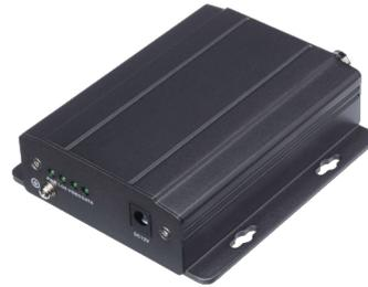
Der L-ZU-1520 ist ein Konverter von HD-CVI auf LWL (Glasfaser) und fungiert als Sender für den Empfänger (L-ZU-1521). Diese Ausführung unterstützt Singlemode. Die Übertragungreichweite beträgt bis zu 20 km. Die Stromversorgung erfolgt über 12 V DC / 1A. Ein Netzteil ist nicht im Lieferumfang.
