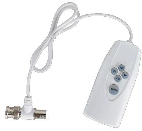
Der UTC-Controller L-ZU-1760 dient zur Steuerung des OSD-Menüs von Überwachungskameras. Hierzu wird der Controller in das Videosignal eingeschleift (BNC-Stecker und BNC-Buchse). Der Controller unterstützt HD-CVI, AHD, HDTV und CVBS. Eine LED zeigt das aktuell eingestellte Format an. Die Kabellänge am Controller beträgt ca. 56 cm. **Achtung: Den Controller nicht an PoC-Rekordern verwenden!**
