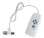
Der UTC-Controller L-ZU-1760 dient zur Steuerung des OSD-Menüs von Überwachungskameras. Hierzu wird der Controller in das Videosignal eingeschleift (BNC-Stecker und BNC-Buchse). Der Controller unterstützt HD-CVI, AHD, HDTVI und CVBS. Eine LED zeigt das aktuell eingestellte Format an. Die Kabellänge am Controller beträgt ca. 56 cm. **Achtung: Den Controller nicht an PoC-Rekordern verwenden!**
