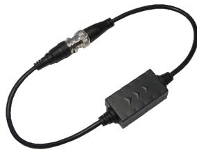
Der L-ZU-1770 ist ein passiver, galvanischer Video-Trenntrafo für HD-CVI und dient zur Vermeidung von Brummschleifen im Videosignal. Dieses Brummen kann aufgrund eines Potentialgefälles bei größeren Entfernung auftreten. Der L-ZU-1770 wird an der Rekorderseite zwischengeschaltet und filtert diese Störsignale heraus. Durch seine geringe Größe ist er flexibel auch in bestehende Systeme integrierbar.
