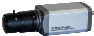
Die L-BN-2501 ist eine HD-CVI Box-Kamera. Passende Objektive (nicht im Lieferumfang) werden über CS angeschlossen. Der DSP (Signalprozessor) der Kamera ermöglicht zahlreiche Einstellungen für optimale Bildqualität auch bei schwierigen Lichtverhältnissen. Das OSD-Menü der Kamera wird über den Rekorder gesteuert. Die Spannungsversorgung erfolgt über 230 V AC.
