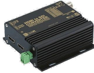
Der L-ZU-1410 ist ein Konverter für HDMI auf HD-SDI. Der Konverter besitzt einen HDMI-Eingang, einen HDMI-Ausgang (durchgeschleift) und einen SDI Ausgang. Somit fungiert das Gerät gleichzeitig auch als Verteiler. Das SDI-Videosignal kann am Gerät eingestellt werden (Scaler). PoC (Power over Coax) wird unterstützt (12 V DC / 8 W). Die Stromversorgung erfolgt über 12 V DC. Ein Netzteil ist nicht im Lieferumfang.
