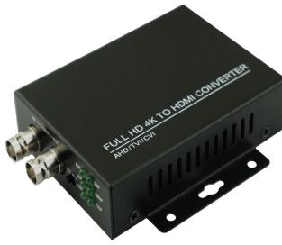
Der L-AHK1 ist ein Konverter für HD (HD-CVI, TVI, AHD) bis 4k, durchgeschleift auf HDMI bis Full HD (1920 x 1080 px). Die Stromversorgung erfolgt über 5 V DC. Das passende USB-Netzteil (Micro USB-B Anschluss) wird mitgeliefert.
