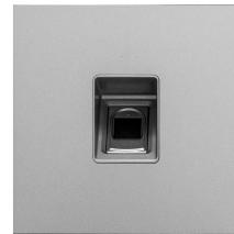
Das L-FP-5700 ist ein Türsprechanlagenmodul für den Außenbereich (IP65) mit Fingerabdrucksensor in einer Alu-Frontplatte und ergänzt das Kamera-Hauptmodul. Eine separate Spannungsversorgung ist nicht nötig, diese erfolgt über den Anschluß zum Hauptmodul. Das L-FP-5700 ist nach IK07 schlagfest. Zusammen mit anderen Modulen (Kamera, Kartenleser, Tastatur) lässt sich flexibel eine Türsprechanlage kombinieren.
