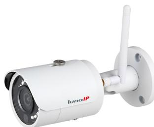
Die L-KC-5400-W ist eine Bulletkamera (IP) im wetterschutzten Gehäuse (IP67) mit WLAN-Unterstützung. Der 1/3" 4 MP CMOS Sensor liefert Bilder in einer Auflösung von bis zu 2560x1440 px mit bis zu 20 fps. Ausgestattet mit einem 2,8 mm Fix-Objektiv und IR-LEDs (Reichweite bis 30 m) ist die Kamera vielseitig einsetzbar. Einstellungen sind über den eingebauten Webserver möglich. Die Spannungsversorgung erfolgt über 12 V DC. (Netzteil im Lieferumfang)
