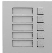
Das L-TA-5705 ist ein Türsprechanlagenmodul für den Außenbereich (IP65) mit einer Aluminium-Frontplatte und 5 Klingeltasten. Es ergänzt das Kamera-Hauptmodul. Eine separate Spannungsversorgung ist nicht nötig, diese erfolgt über den Anschluß zum Hauptmodul. Das L-TA-5705 ist nach IK07 schlagfest. Zusammen mit anderen Modulen (Kamera, Kartenleser, Fingerabdrucksensor und Tastatur) lässt sich flexibel eine Türsprechanlage kombinieren.
