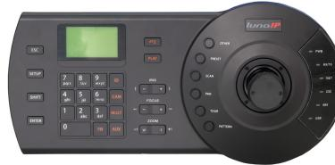
Bedienteil mit 3-Achsen-Joystick zur Steuerung von PTZ-Kameras (Multiprotokoll Pelco D/P, DH-SD) über die RS485- oder RS232-Schnittstelle. Durch den 3D Joystick lassen sich die Funktionen Schwenken, Neigen und Zoom intuitiv bedienen, weitere Funktionen werden über diverse Funktionstasten aufgerufen. Alle Einstellungen werden über ein LCD Display durchgeführt. Die Spannungsversorgung erfolgt über ein im Lieferumfang enthaltenes Netzteil (12 V DC).
