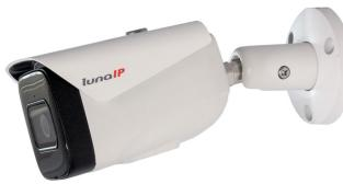
Die L-KD-5400 ist eine 4 Megapixel Bulletkamera (IP) im wettergeschützten Gehäuse (IP67), die neben IVS-Funktionen auch über neueste KI-Technologie verfügt. Der 1/1,8" CMOS Sensor liefert Bilder in einer Auflösung von bis zu 2688x1520 Pixel (bis 25 bps). Ausgestattet mit einem 2,8 mm Fix-Objektiv und IR-LEDs (Reichweite bis 50 m) ist die Kamera vielseitig einsetzbar. Einstellungen sind über den eingebauten Webserver möglich. Die Spannungsversorgung kann wahlweise über 12 V DC oder PoE erfolgen.
