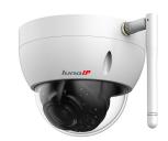
Die L-DC-5400-W ist eine Dome-Kamera (IP) im wetter- und vandalismusgeschützten Gehäuse (IP67, IK10) mit WLAN-Unterstützung. Der 1/3" 4 MP CMOS Sensor liefert Bilder in einer Auflösung von bis zu 2560x1440 px mit bis zu 20 bps. Ausgestattet mit einem 2,8 mm Fix-Objektiv und IR-LEDs (Reichweite bis 30 m) ist die Kamera vielseitig einsetzbar. Einstellungen sind über den eingebauten Webserver möglich. Die Spannungsversorgung erfolgt über 12 V DC.
