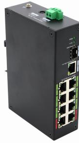
8-fach PoE Switch im Industriedesign mit extra großem Temperatureinsatzbereich von -30 °C ~ +65 °C. Die Gesamt-PoE-Leistung beträgt 120 W (Port 1 & 5: max. 90 W/Port, Rest: max. 30 W/Port).
