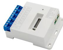
Das **L-IO-5080** ist ein RS-485-Erweiterungsmodul für Zutrittskontrollsysteeme, das zusätzliche Ein- und Ausgänge für vielseitige Sicherheitsanwendungen bereitstellt. Es bietet **8 Alarimeingänge** und **4 Alarmausgänge**, die per Schalter flexibel umkonfiguriert werden können. Durch die Unterstützung von **RS-485-Kommunikation** lässt sich das Modul nahtlos in bestehende Systeme integrieren und ermöglicht die **Kaskadierung von bis zu 20 Geräten**.
